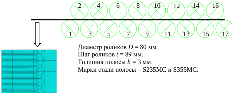
Рис. 4. Настройка конечно-элементной модели правки полосы в 17-роликовой правильной машине
